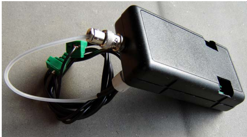
Preamplificatori per i due sensori capacitivi.
